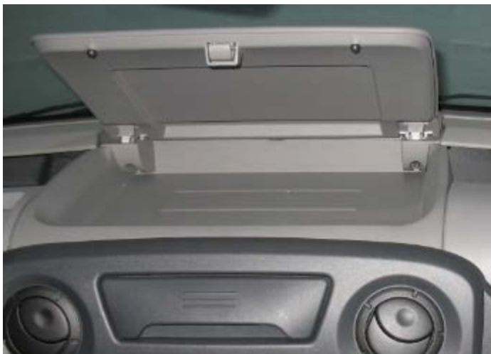
Fach oben mit Deckel aufgeklappt (Abmessungen ca. 290 x390 x50mm)
