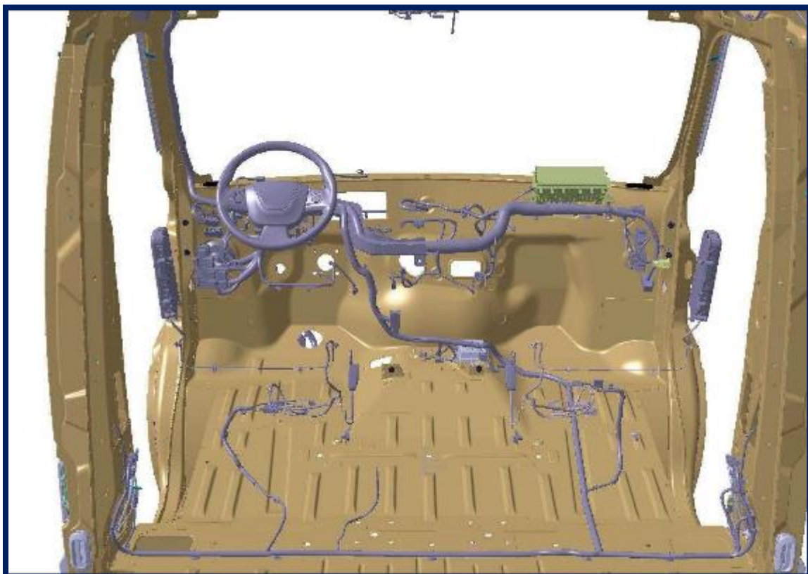
Verkabelung beim Linkslenker
