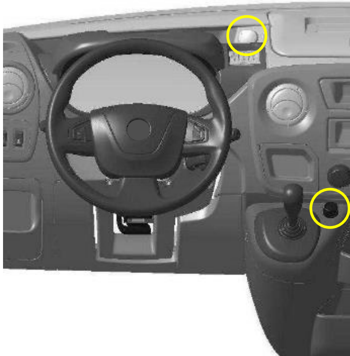
Lage der Zubehörsteckdosen im Armaturenbrett
